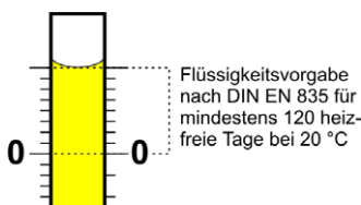
Abb. 1: Alle Heizkostenverteiler nach dem Verdunstungsprinzip besitzen eine Überfüllung für den Sommer.
